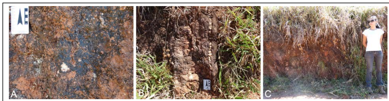
Figura 2 – A) Impregnações de manganês em solo. B) Veio de quartzo vertical. C) Foliação (xistosidade) subvertical.
