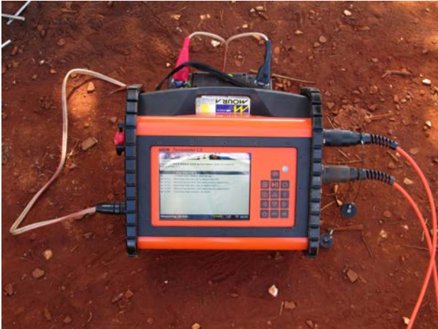
Foto 1 – Resistivímetro ABEM Terrameter LS.
