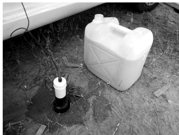
Figura 04 – Eletrodo base, utilizado na aquisição de SP.
