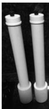
Figura 03 - Eletrodos não polarizáveis construídos com tubos de PVC, fios de cobre e bases cerâmicas.
