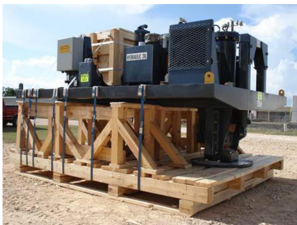
Figura 1: Fonte sísmica do tipo Accelerated Weight Drop com potência média, capaz de gerar um pulso em torno 10.000 Joules para uma pressão de nitrogênio de 700 PSI, disponível no mercado internacional, a qual será acoplada a um caminhão de fabricação nacional.
