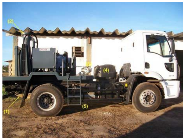
Figura 3 : Resultado da montagem da fonte AWD sobre o caminhão de fabricação nacional, onde pode-se ver: (1) a placa que se acopla ao solo, (2) a torre onde ocorre a expansão do nitrogênio, (3) o tubo de nitrogênio comprimido, (4) a nova posição do tanque de combustível no caminhão e (5) pára-choque lateral (mata cachorro) exigido por lei.
