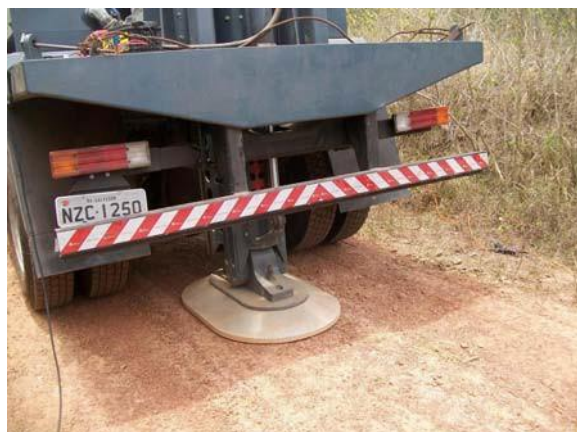
Figura 4: Placa acoplada ao solo sob o peso da carroceria do caminhão, aguardando o impacto do martelo, e a 1,5 m do geofone na beira da estrada.
