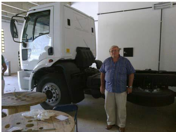
Figura 2 : Caminhão de fabricação nacional, modelo Ford 1717e, o qual tem dimensões e peso compatível com a fonte sísmica de queda de peso com aceleração de porte médio (AWD F450).
