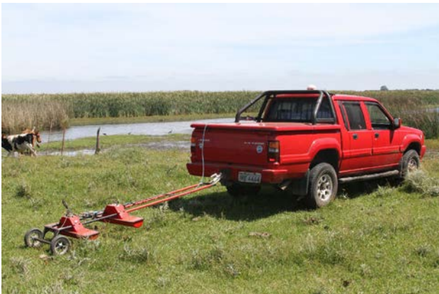
Figura 3 – Arranjo bi estático utilizando antenas aéreas com frequência central de 150 MHz acopladas a um veículo para aquisição em terrenos sem obstáculos.
