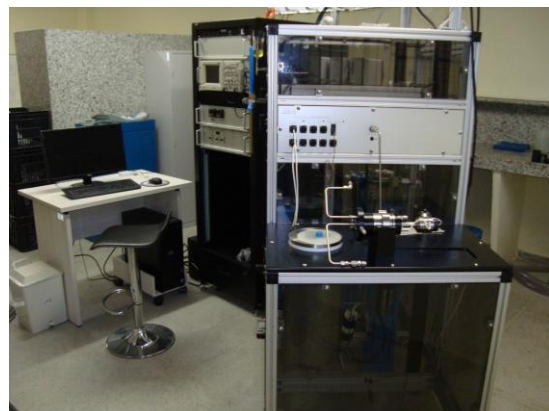
Figura 5 - Câmara de medição de velocidades elásticas.
