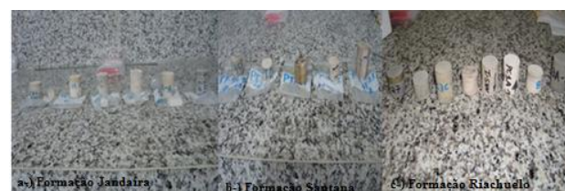
Figura 3 - Plugues extraídos de amostras de rochas carbonáticas.
