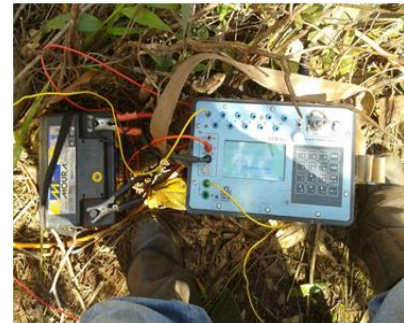
Figura 3 – Fotografia do eletrorresistivímetro multieletródico SYSCAL PRO usado em campo.
