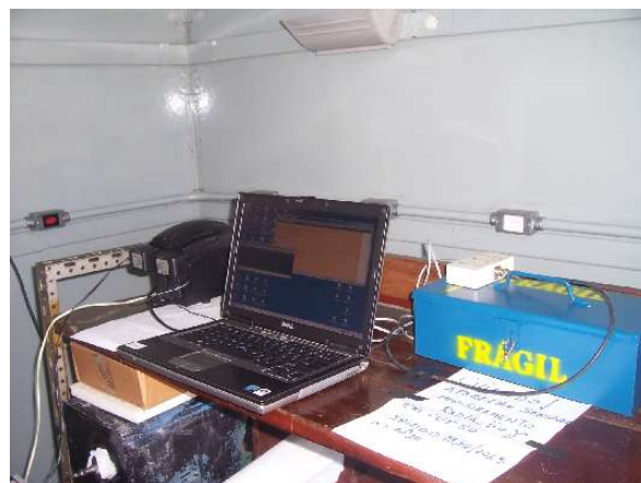
Figura 3 – Sistema compacto de detecção de raios gama. O cintilador encontra-se dentro da caixa de metal azul.
