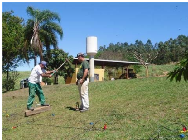
Foto 1 - Levantamento sísmico de refração gerando e registrando a onda S.
