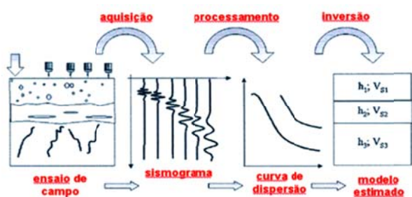
Figura 1 - Ilustração das etapas de um ensaio MASW (modificado de Strobbia, 2003).
