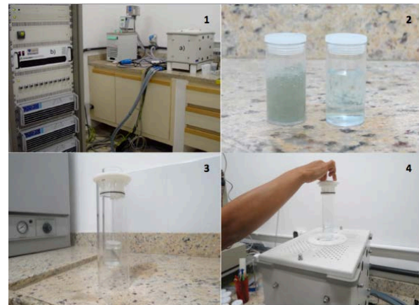
Figura 1 – 1- Equipamento Ressonância Magnética Nuclear (RMN) (Maran Ultra 23 MHz - Oxford Instruments, UK); 2- amostras sintéticas e água com sulfato de cobre ( CuSO_4 ); 3- tubo de ensaio com as amostras dentro de calibrador para centralização ao campo magnético ; 4- introdução do tubo de ensaio com as amostras no equipamento.
