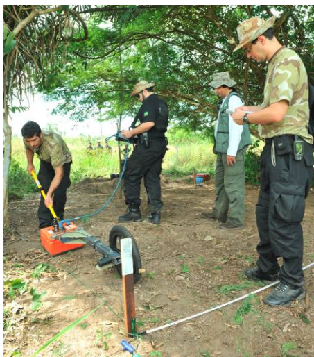
Figura 3 – Levantamento de GPR utilizando o equipamento SIR3000, fabricado pela empresa GSSI, acoplado a uma antena blindada de com frequência central em 400MHz.
