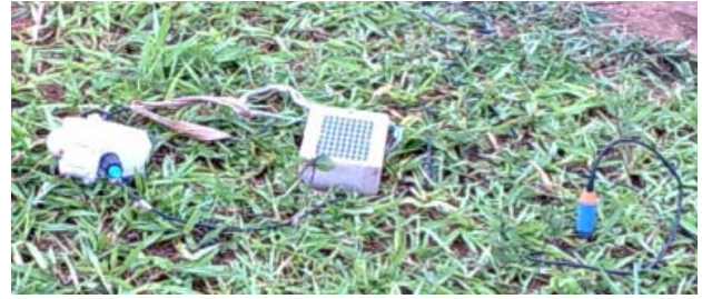
Figura 3 - Unidades de aquisição wireless, bateria externa e sensor (uma de seis bobinas).
