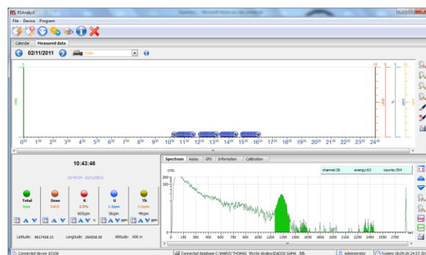
Figura 9 – Espectro com valor de fundo de potássio associado a um alto topográfico sem afloramentos de granito.
