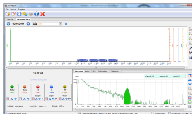
Figura 10 – Espectro com valor de fundo de potássio associado a um alto topográfico com afloramentos de granito.
