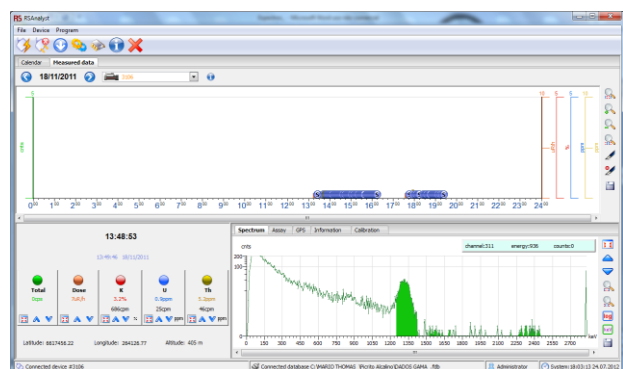
Figura 7 – Espectro com valor anômalo de potássio, associado a um alto topográfico sem afloramentos de granito.
