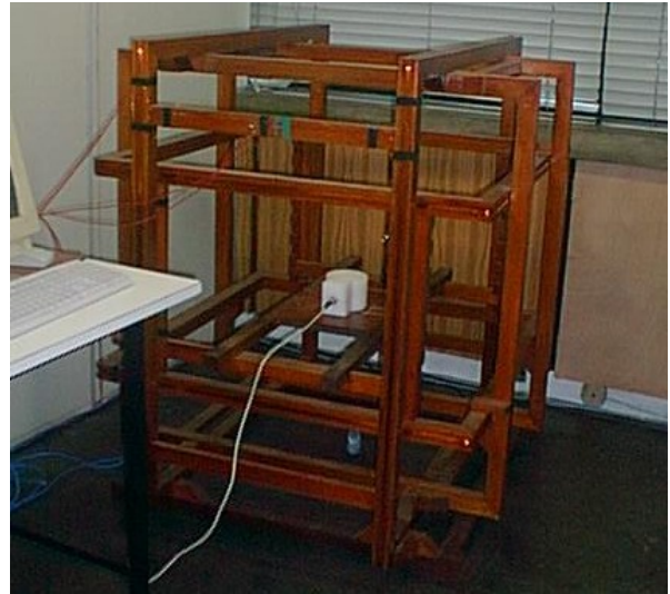
Figura 4 – Testes com o sensor amorfo em bobina de Helmholtz.
