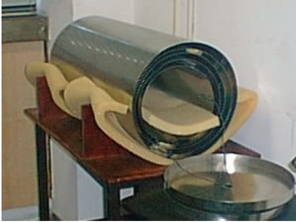
Figura 3 – Blindagem magnética em mu-metal de cinco camadas do LDSM/ON, utilizada para avaliação de ruído próprio e deriva de sensores magnéticos.
