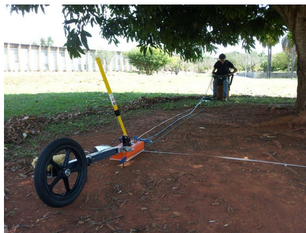
Figura 2: Foto evidencia o sistema GPR utilizado na aquisição de dados.
