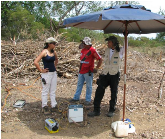
FIGURA 4: Foto evidencia a aquisição de dados de eletrorresistividade com o equipamento Syscal Pro 72.
