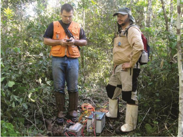
Figura 03: Ilustração da montagem do equipamento SYSCAL-PRO.
