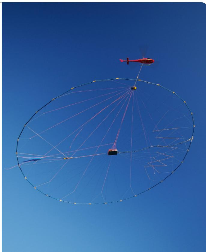
Operação do método EM por helicóptero (HeliTEM)
