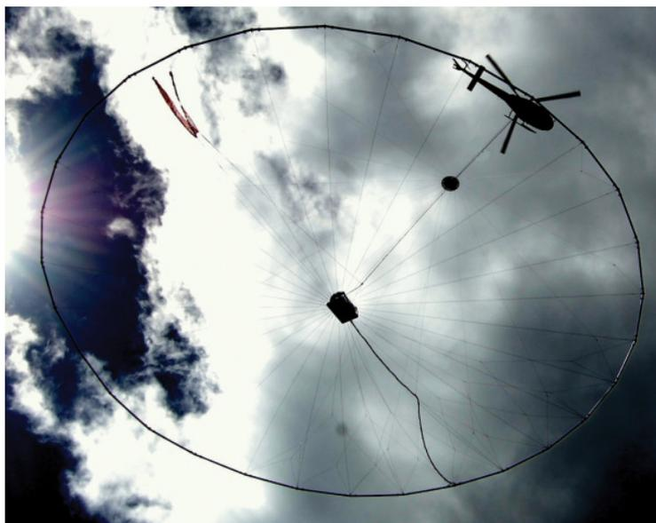
Operação do método EM por helicóptero (HelITEM)
