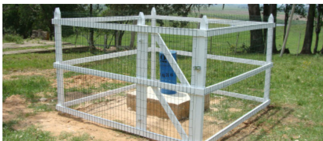
Estação de Monitoramento do Sistema Aquífero Guarani localizada na Escola Agrícola Municipal de Santana do Livramento (RS)
