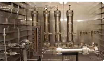
Equipamento de análise de permeabilidade relativa em condição de reservatório (pressões, temperatura e fluidos de reservatório em rocha com molhabilidade restaurada)
