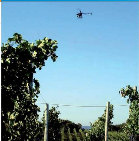
Sensor multiespectral aeroportado controlado remotamente imageando vinhedo em Bento Gonçalves, Rio Grande do Sul
