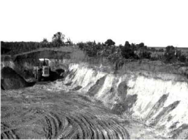
Figura 3 – Exploração de minerais pesados no litoral norte do estado do Rio de Janeiro, em áreas de concessão das Indústrias Nucleares Brasileiras. A exploração é feita por intermédio de pás carregadeiras e as areias são transportadas para a usina de beneficiamento da empresa localizada no vilarejo de Buena. O rejeito é trazido de volta para a área de exploração, recompondo a topografia original.
