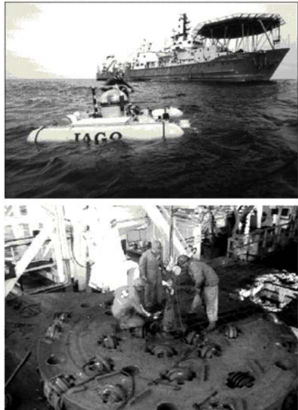
Figura 4 – No alto, navio sonda e submarino utilizados pela De Beers para exploração de diamantes na costa da África do Sul e Namíbia ( www.debeersgroup.com ). A foto inferior mostra detalhes da cabeça da sonda rotativa modelo “Wirth Drill”, utilizada pela Diamond Fields International na exploração de diamantes na Namíbia ( www.diamondfields.com ).
