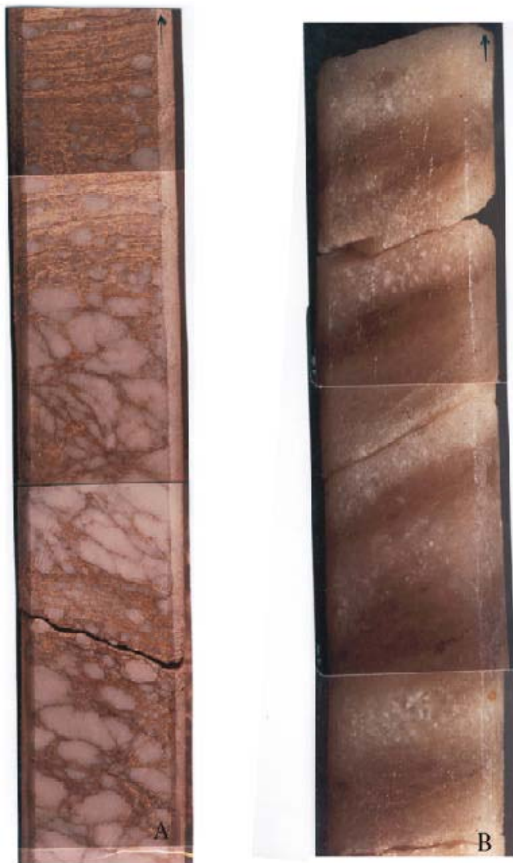
Figura 4 – (A) Nódulos de anidrita. (B) Halita bandeada com matéria orgânica, exemplos do Membro Ibura da Formação Muribeca, Aptiano da Bacia de Sergipe. A seta corresponde a cerca de 1cm aproximadamente.
