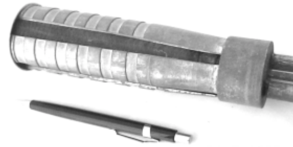
Fig. 4 – Detalhe do sistema pneumático inflado, para fixação da fonte na cota de ensaio.
