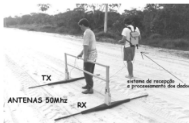
Figura 6 – Operação de campo para aquisição de dados com antena de 50 MHz.
