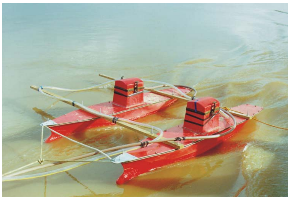
Figura 5 – Catamarãs com as antenas de 100 MHz durante a aquisição de uma seção GPR ao longo do Rio Taquari.
