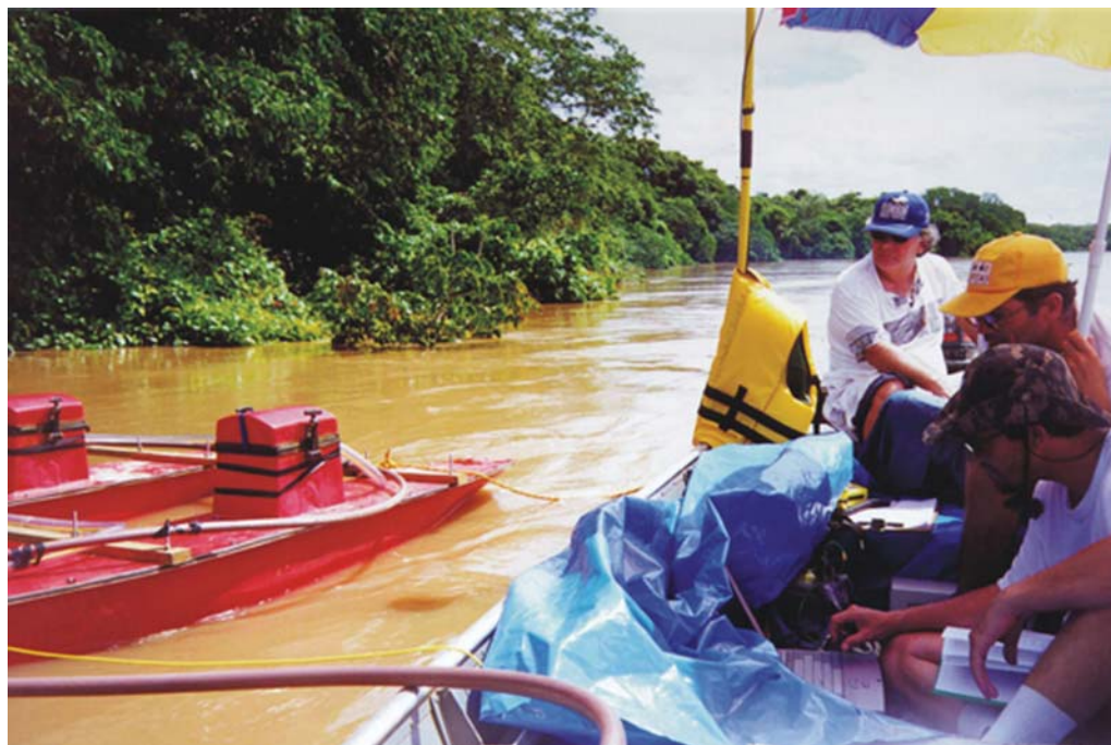
Figura 4 – Equipamento GPR arranjado numa embarcação de alumínio, o sistema GPS e os catamarãs com as antenas.
