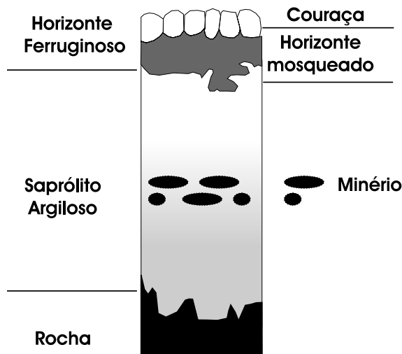
Figura 3 – Perfil de intemperismo presente na jazida da Fazenda Extrema.
