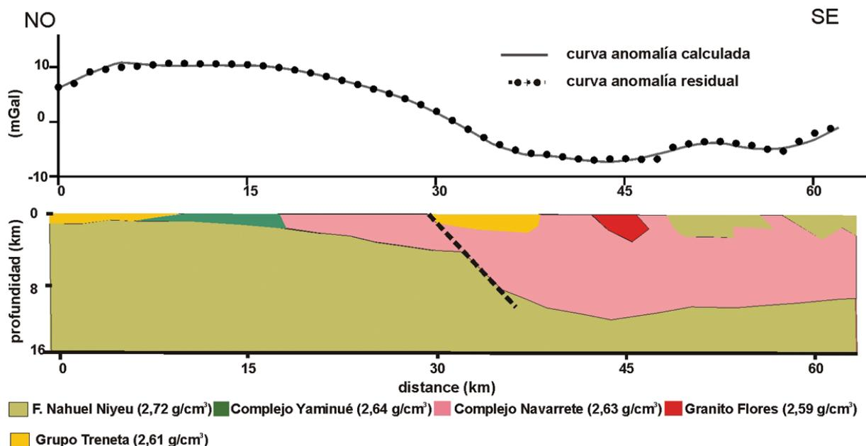
**Figura 6** – Modelo de densidad a lo largo del perfil A-A' (ver ubicación en la Fig. 2). Las densidades utilizadas, fueron las obtenidas a través de muestreo (ver Tab. 1). Así para la Formación Nahuel Niyeu se utilizó: 2,72 g/cm<sup>3</sup>; Complejo Navarrete, 2,63 g/cm<sup>3</sup>; Complejo Yaminué, 2,64 g/cm<sup>3</sup>; Granito Flores, 2,59 g/cm<sup>3</sup>; Grupo Treneta, 2,61 g/cm<sup>3</sup>.
