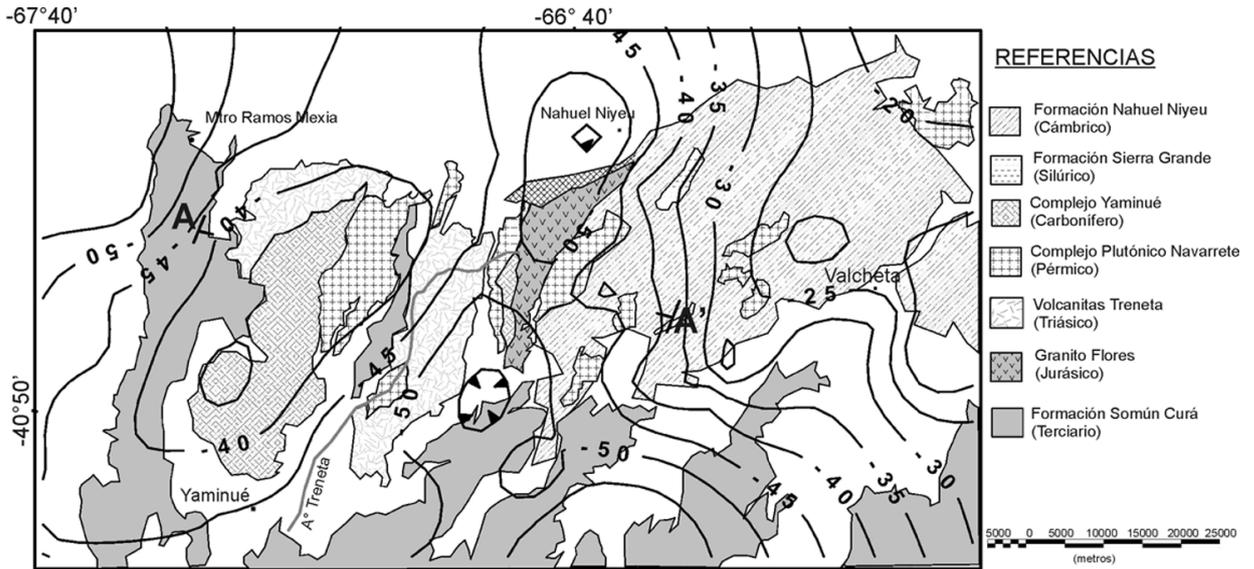
**Figura 2** – Mapa de anomalía de Bouguer completa calculada en el Sistema Internacional de Referencia de 1971. Método de grillado Mínima Curvatura. Isoanómalas cada 5 mGal. A-A' perfil modelado en Figuras 5 y 6.
