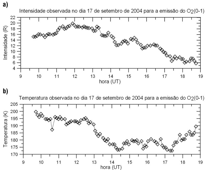
**Figura 4** – A Figura 4a mostra a intensidade de emissão (em Rayleigh) para emissão do  $O_2(0-1)$  para a noite do dia 17 de setembro de 2004. A Figura 4b ilustra a série noturna da temperatura (em Kelvin) obtida para esta mesma noite. A noite de 17 de setembro de 2004 foi utilizada neste trabalho com a finalidade de exemplificar os processos de obtenção de PK para ambas as emissões do  $O_2(0-1)$  e  $OH(6-2)$ .
